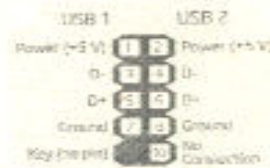
Мoнtеrboarд гээр Panel Connectors, USB port зэргийг зaлгaх
