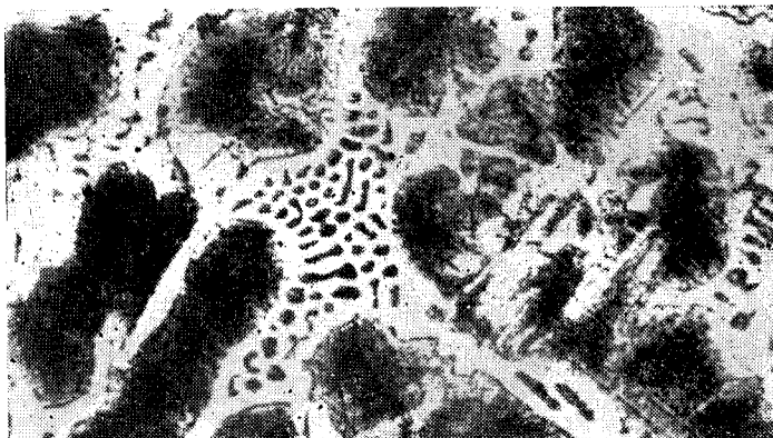
Рис. 40. Микроструктура доэвтектического белого чугуна, \times 100
