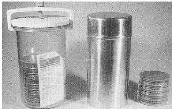
Фото 1.3 Анаэростат, хүчилтөрөгч шингээгч системтэй ашиглаж болно.
