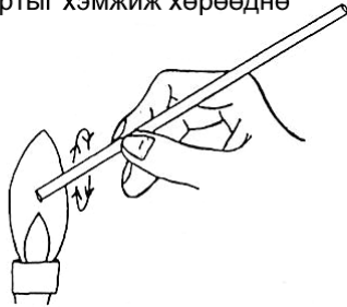
3 Хоёр талын үзүүрийг дөлөнд барьжмөлгөр болгоно. Хөргөсний дараа угааж хатаана.
